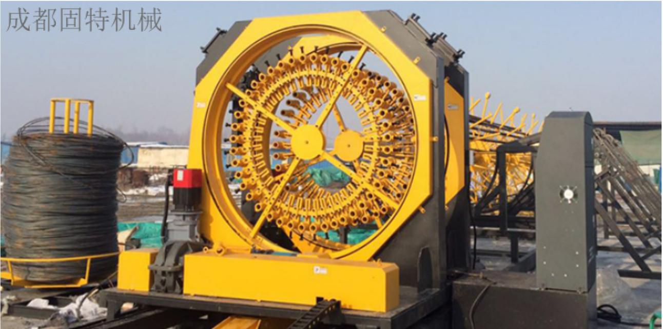
钢筋笼滚焊机工作原理是什么？钢筋笼滚焊机是适应现在的工程施工现状应运而生的一种钢筋笼加工设备，制作钢筋笼的速度也提高了几倍，所以钢筋笼绕筋机就跟快的占有了市场，被跟多的施工单位所采用。钢筋笼滚焊机的出现，解决了传统钢筋笼无法双盘筋同时缠绕的问题，且钢筋笼绕筋机钢筋笼制作标准，效率高，省时省人工，对于不同直径的钢筋笼切换设备不用可以调节，使用方便灵活。钢筋笼滚焊机是一种专门缠绕钢筋笼外部绕筋的数控设备。施工单位用人工把钢筋笼的主筋和内部加强圈焊接成钢筋笼的大致骨架，然后放到钢筋笼滚焊机上进行绕筋的缠绕。根据施工要求，首先调整钢筋笼滚焊机两滚筒间距离，将钢筋笼的筋架预制好吊装到钢筋笼绕筋机两滚筒之间，通过穿过矫直器将盘筋穿入钢筋笼，把盘筋（绕筋）断头先焊接在一根主筋上，然后通过固定旋转及移动旋转盘转动把绕筋缠绕在主筋上，同时进行焊接，从而形成产品钢筋笼，这就是钻孔灌注桩钢筋笼滚焊机。
